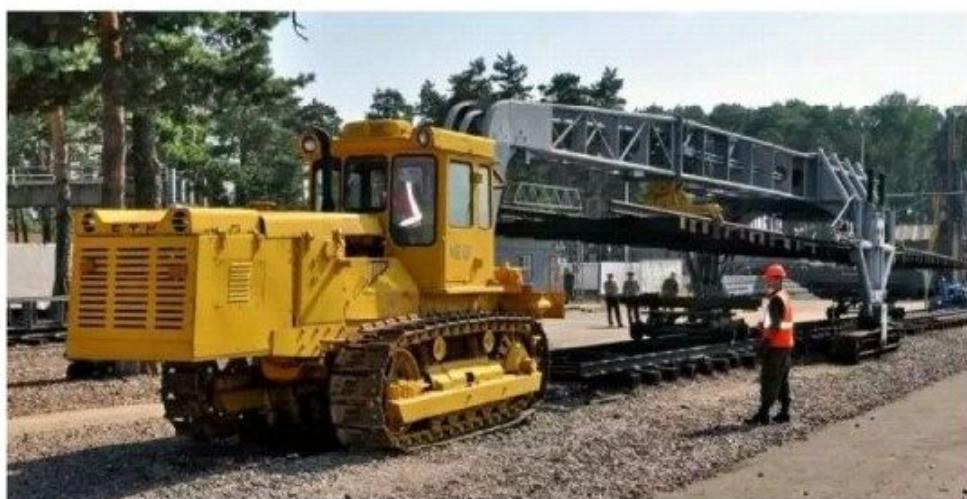
Лекция началась: "Товарищи офицеры! Путеукладчик ПБ-3, это ракета желдорвойск! Наша ракета!" ( Мне представилось, как "наша ракета" стремительно парит над земполотном со скоростью 2 км/час, укладывая звенья пути). "Он обладает... Состоит из трактора, прицепного устройства, дышла, ящика, в котором все, что нужно...
